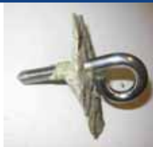
Nový předpisově osazený borhák při 1.500 kN vydržel, žula však ne. A co vaše karabiny. Vydrží 2.000 kN nebo ještě víc?
